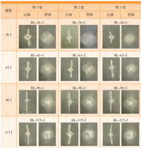
图4 玻璃纤维试件冲击损伤
