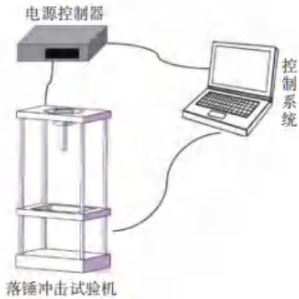
图1 落锤冲击试验平台示意图
