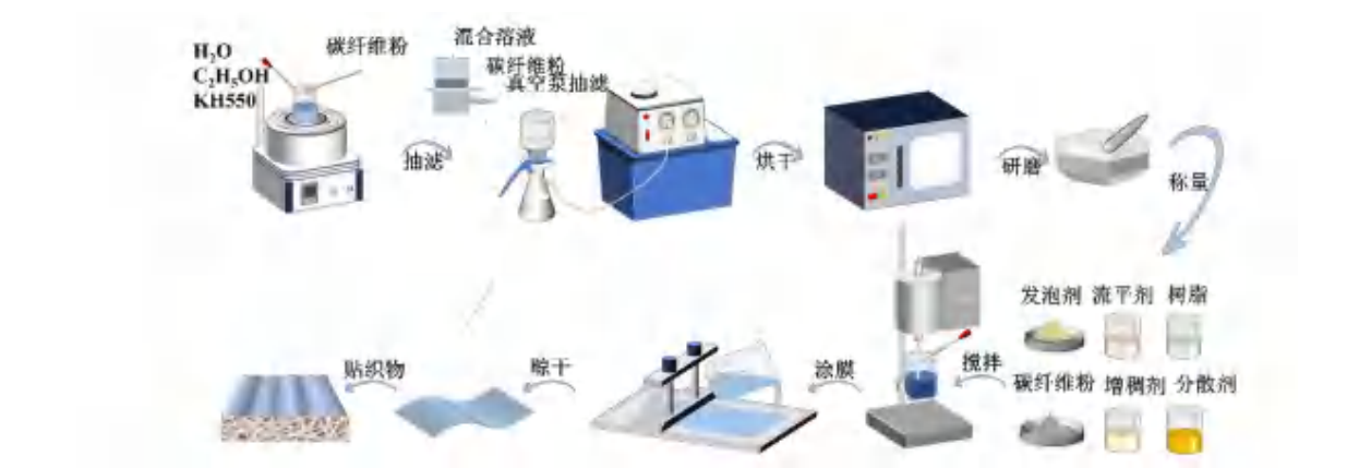
图2 改性碳纤维粉/预氧丝/芳纶毡复合材料的制备工艺流程图
