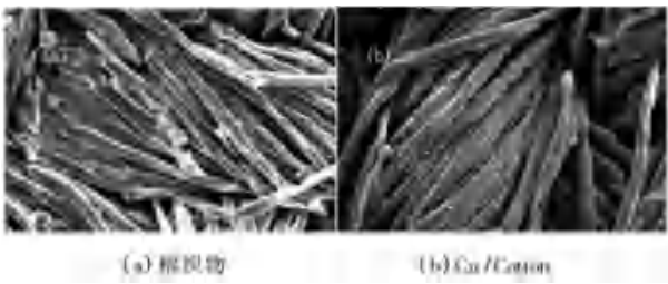
图2 棉织物与 Cu /Cotton 的扫描电镜图
